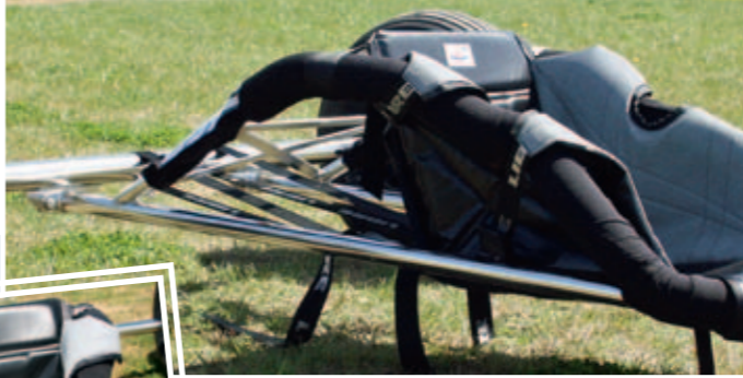
Mit Unterzug und Rahmenverstrebung am Heck wird eine hohe Steifigkeit erzielt
