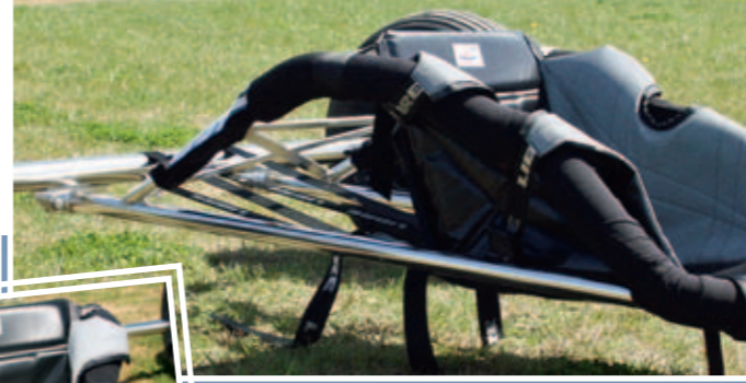
Mit Unterzug und Rahmenverstrebung am Heck wird eine hohe Steifigkeit erzielt
