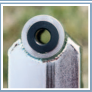
Lenkkopfbuchse an der robust ausgelegten Deichsel
