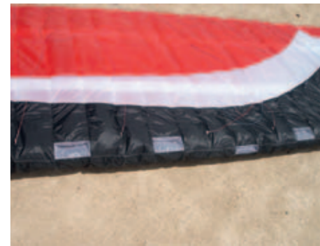
■ Flügelausformung durch Ventile und dünne Metallfedern
